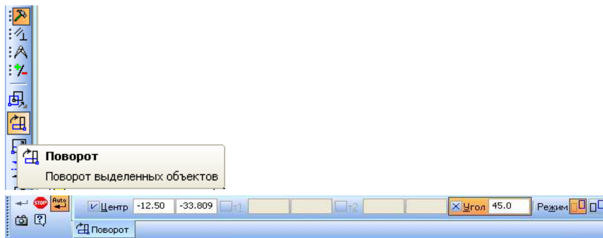
Рис. 48. Поворот предварительного эскиза лысок
