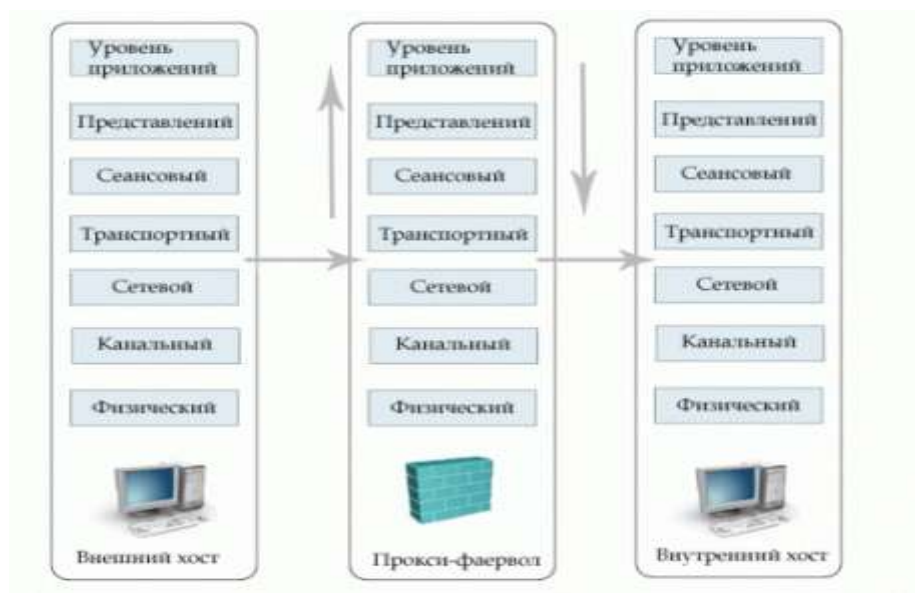
Рисунок 10. Установка соединения через прокси-фаервол
